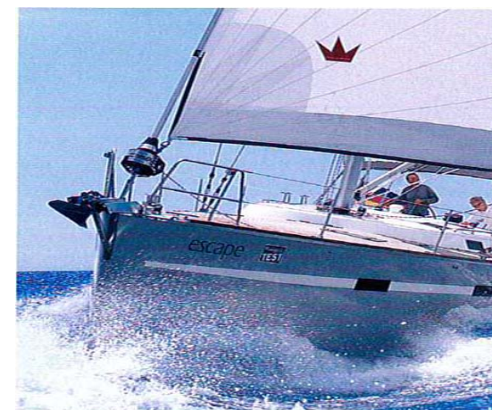
Суженный форштевень яхты прекрасно действует в условиях сильного волнения
